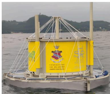
Questo strumento permette di **monitorare alcuni parametri fondamentali** per la vita nell'acqua, tra cui la temperatura a vari livelli di profondità, l'acidità (pH), la conducibilità elettrica, l'ossigeno disciolto, la forza del vento e la presenza di pigmenti algali.
